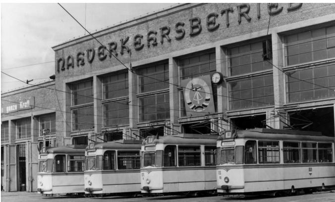
Vor der 1956 neu errichteten Halle des Betriebshofes Hamburger Straße stehen die Wagen (v.r.n.l.) 10, 6, 11 und 15. Gut zu erkennen sind die ab 1963 bereits werkseitig angebauten und später wieder entfernten Fangkörbe an den Wagen. Wagen 11 ist noch nicht für den OS-Verkehr ausgerüstet.
