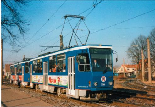
Den Bereich der Wendeschleife Reuthagen befährt 704 als führender Triebwagen einer Traktion bereits im teilmodernisierten Zustand mit Klappfenstern und modernen Zielanzeigen.
