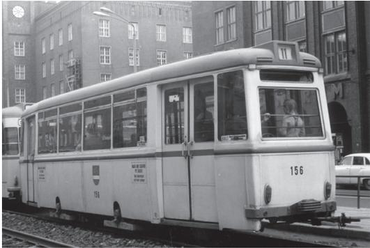
*Im Mai 1968 ist der Beiwagen 156 in der Langen Straße noch mit Türen auf beiden Seiten unterwegs - die linksseitigen Türen sind jedoch verschlossen, da sie für den Betrieb hinter den G4-Gelenktriebwagen nicht benötigt werden.*
